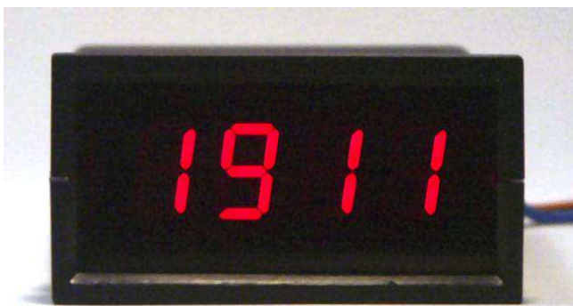
Miernik w obudowie KM-61
